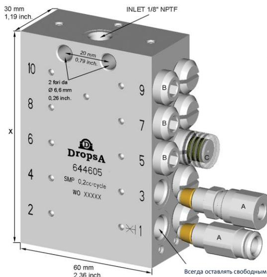
Расход на примыкающих выходах может комбинироваться посредством закрытия заглушкой одного или нескольких выходов. Например, при закрытии заглушкой выхода № 8 смазка направляется на соседний выход (например, № 6) в убывающем порядке. В случае закрытия заглушкой выхода № 2 смазка направляется на выход № 1. **Выход № 1 никогда не должен закрываться заглушкой.**
