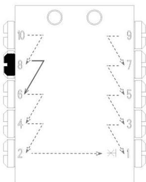
Расход на примыкающих выходах может комбинироваться посредством закрытия заглушкой одного или нескольких выходов. Например, при закрытии заглушкой выхода № 8 смазка направляется на соседний выход (например, № 6) в убывающем порядке. В случае закрытия заглушкой выхода № 2 смазка направляется на выход № 1.
