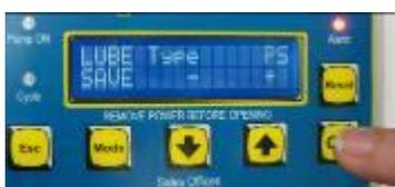
После того как режим выбран, нажмите кнопку **OK** для программирования следующего параметра.
