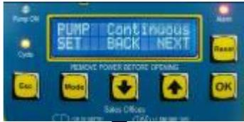
**CONTINUOUS** Постоянное: Это значение по умолчанию, которое позволяет управлять как электрическим так и возвратно-поступательным пневматическим насосом, требующим постоянную подачу питания.
