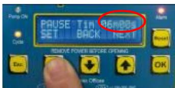
Таймер **PAUSE** задает контроллеру VIP5 время, через которое контроллер будет включать насос для начала нового цикла смазки. Установка по умолчанию 6 минут
