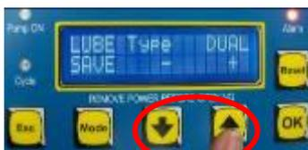
и используйте кнопки стрелки **ВВЕРХ** и **ВНИЗ** для изменения типа системы смазки.
