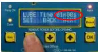
Если выбран режим **TIMER** вы должны указать, какое время должен работать насос в каждом цикле смазки. Для других режимов работы время работы насоса устанавливается автоматически по сигналу датчика цикла.
