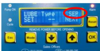
По умолчанию установлена система **SEP** - прогрессивная система.
