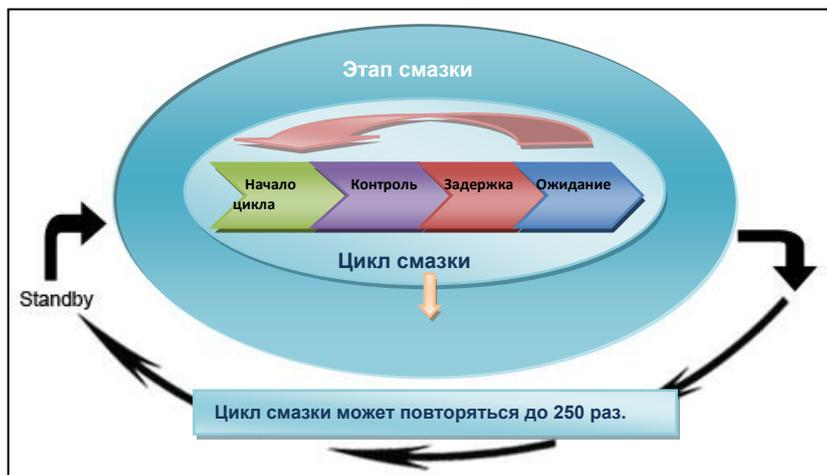
Рис.1 Этап смазки может включать несколько циклов смазки
