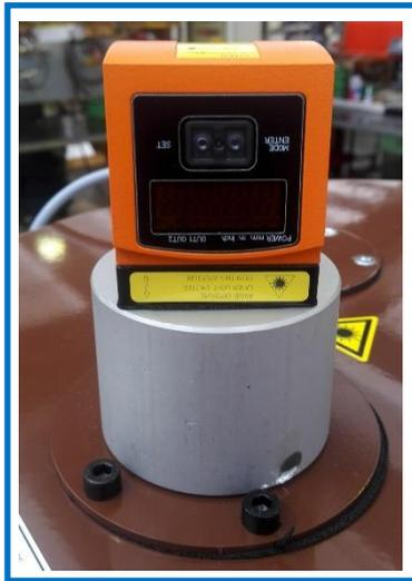
Лазерный зонд имеет встроенный дисплей для визуализации и программирования. Может работать в аналоговом (с сигналом от 4 до 20 мА) или в цифровом режиме (два выхода и четыре порога переключения).
